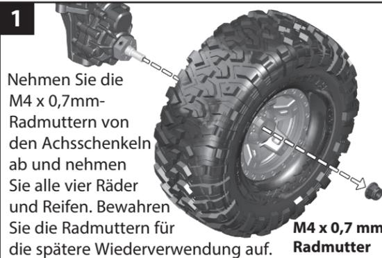
1 Nehmen Sie die M4 x 0,7mm-Radmutter von den Achsschenkeln ab und nehmen Sie alle vier Räder und Reifen. Bewahren Sie die Radmutter für die spätere Wiederverwendung auf.
