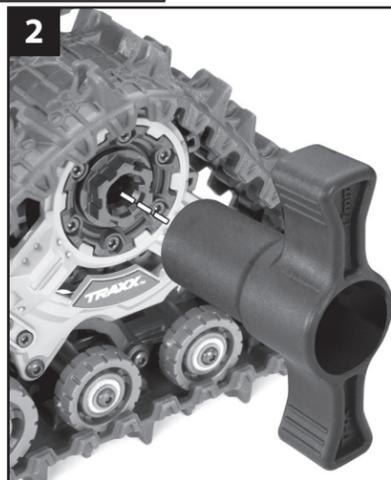
2 Entfernen Sie die Achsschenkelmutter aus den Traxx-Antriebseinheiten mit dem mitgelieferten 17mm Radmutternschlüssel.
